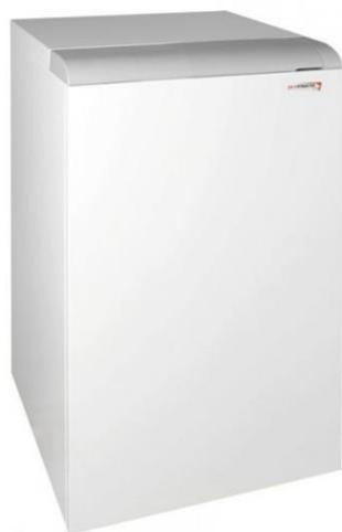
Напольные чугунные газовые котлы мощностью от 18 до 45 кВт для отопления и приготовления горячей воды во внешнем бойлере. Предназначены для систем с естественной циркуляцией теплоносителя. Электронезависимы, не требуют подключения к электрической сети ~220В. Предназначены для установки в жилых домах, дачных домиках и производственных помещениях. Розжиг котла осуществляется при помощи пьезоэлемента. 1-но ступенчатое регулирование мощности котла.
