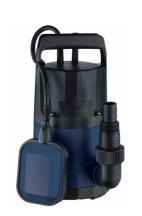
Termica (Термика) CW представляет собой бытовой дренажный насос, предназначен для перекачивания холодной воды из емкости или резервуара. Перекачиваемая вода не должна содержать механические примеси диаметром более 5мм. Прибор укомплектован поплавковым выключателем, который автоматически завершает работу насоса при падении уровня воды в резервуаре нижнее определенного уровня.
