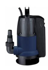
**Дренажный насос Termica (Термика) DW 400 AV** относится к оборудованию погружного типа. Модель рассчитана на перекачивание сточной или другой слабозагрязненной воды, где нерастворимые примеси имеют диаметр не более 35 миллиметров. Конструкция насоса оснащена встроенным поплавковым выключателем, который контролирует работу устройства в автоматическом режиме, и кабелем, длиной 10 метров.
